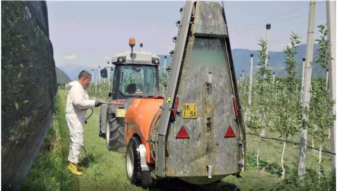
Abbildung 7: Außenreinigung des Sprüher im behandelten Feld
