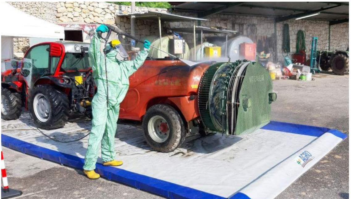
Abbildung 11: Mobile Waschfläche zur Verwendung auf festem Untergrund
