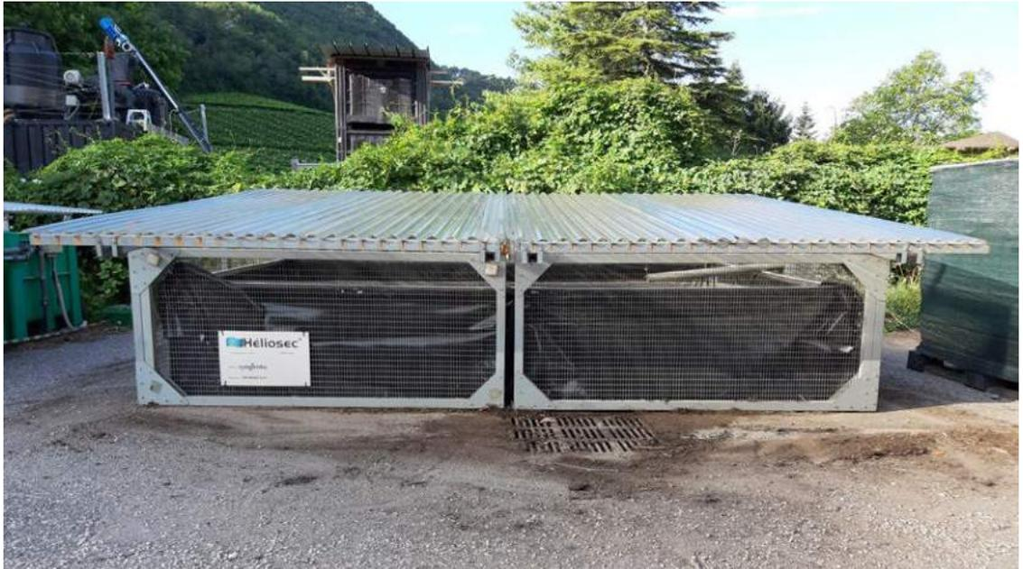
Abbildung 18: Physikalische Verdunstungsanlage Heliosec der Firma Syngenta
