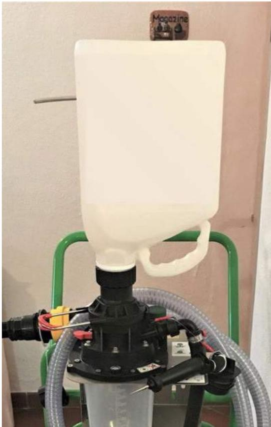
Abbildung 5: Geschlossenes Befüllsystem für PSM
