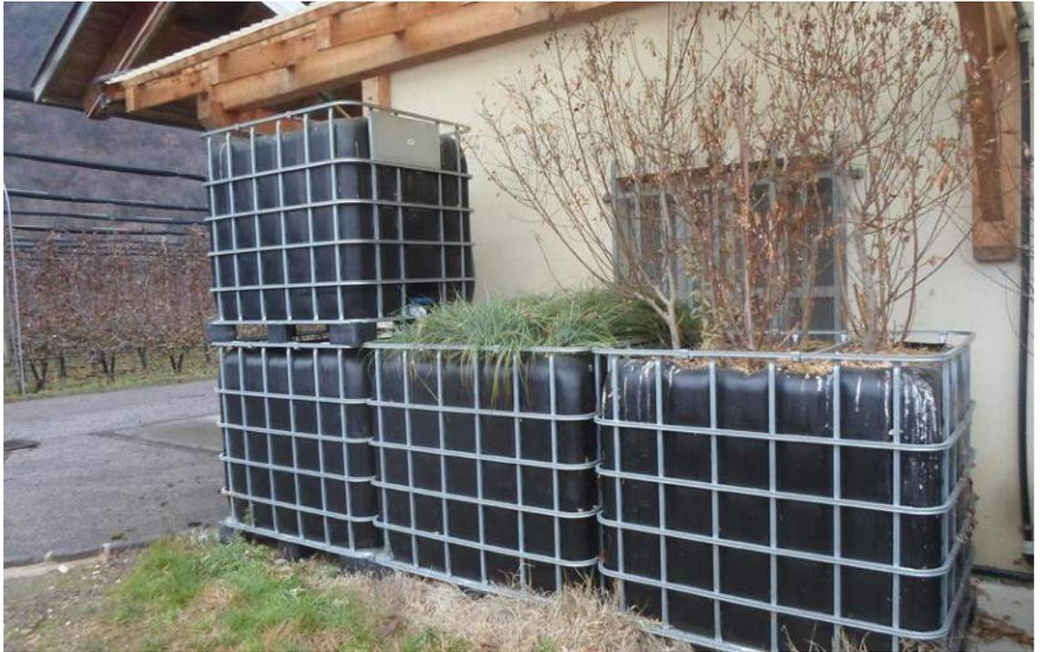
Abbildung 15: Biofilter am Versuchszentrum Laimburg realisiert in Eigenbauweise nach der Anleitung von Pcfruit (Belgien)
