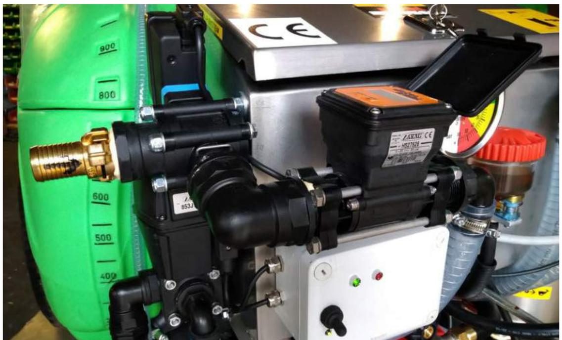
Abbildung 4: Wasserbefüllsystem
