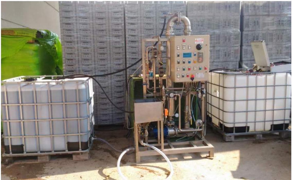
Abbildung 20: Ultrafiltrationsanlage für die Reinigung und Wiederverwendung des Wassers
