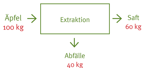
Abbildung 3.4: Ausschnitt aus dem Herstellungsprozess. Aus 100 kg Äpfeln werden 60 kg Saft gewonnen. Dabei entstehen Abfälle im Ausmaß von 40 kg. Daraus lässt sich die Prozessausbeute berechnen.
