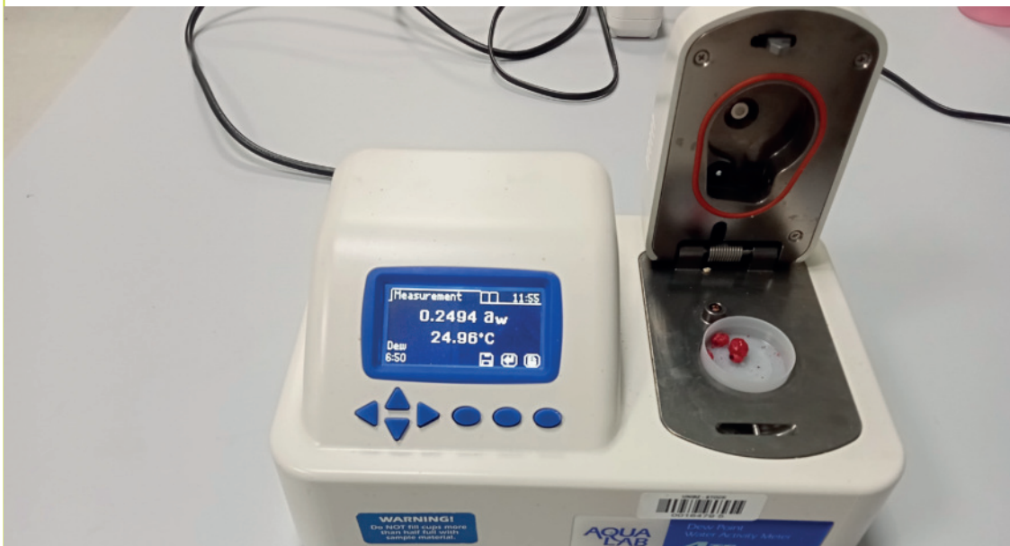
Abbildung 4.5: Die Wasseraktivität eines Produktes kann mittels spezieller Messgeräte erfasst werden. Die Wasseraktivität eines Produktes kann mittels entsprechenden Thermowaagen gemessen werden. Eine Vielzahl an Laboren kann hier genaue Analysen durchführen.
