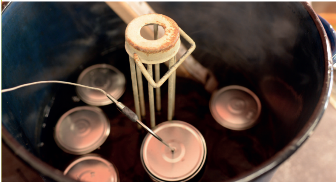
Abbildung 7.5: Während der Pasteurisierung muss die Temperaturkurve mithilfe einer Temperatursonde kontrolliert werden. Erst sobald im Produktinneren die erforderliche Temperatur erreicht wird, beginnt die Pasteurisierung.
