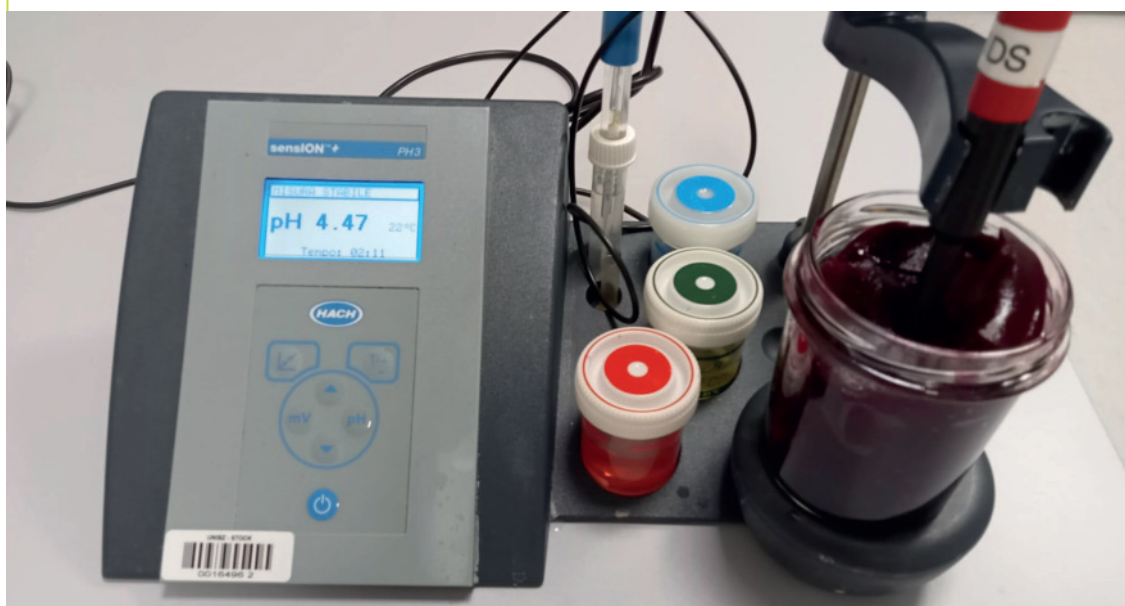
Abbildung 7.6: Qualitätskontrolle nach abgeschlossener Pasteurisierung. Mit dem pH-Meter wird der pH-Wert sowohl in der Lake als auch im Inneren der Rohnen-Scheiben gemessen, um die Lebensmittelsicherheit zu kontrollieren.
