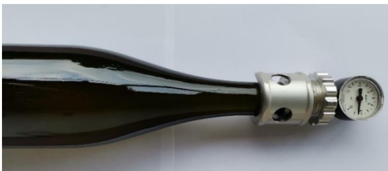
Abbildung 2: Der Innendruck wird mit einem Aphrometer gemessen. Übersteigt der Innendruck die Widerstandsfähigkeit der Flasche, so wird diese zerstört. Bei der Kohlendioxid-Zugabe durch Fermentation dient das Aphrometer auch zum Monitoring und hilft bei der Steuerung der
