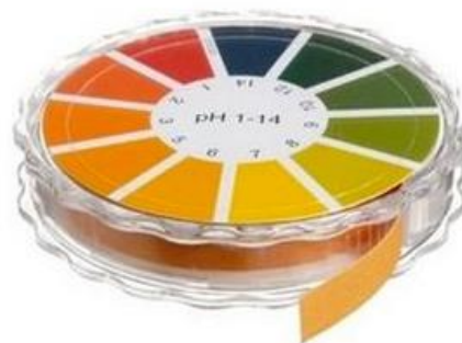
Abbildung 8: Indikatorpapier kann zur Messung des pH-Werts verwendet werden. Im Gegensatz zum pH-Meter sind diese kostengünstig, jedoch ungenau und können vor allem bei farbigen Flüssigkeiten zu einer falschen Interpretation der Ergebnisse führen.
