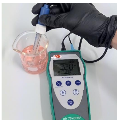
Abbildung 7: pH-Meter liefern sehr genaue Messwerte. Bei Nichtverwendung muss die Elektrode in einer geeigneten Flüssigkeit gelagert werden.
